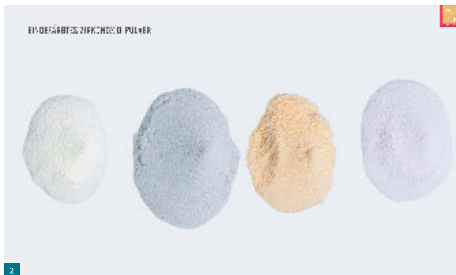
Abb. 2 Zirkonoxid wird meist aus Pulver (Zirkonium) hergestellt, dem verschiedene Zusätze (zum Beispiel Yttrium) beigemischt werden.
