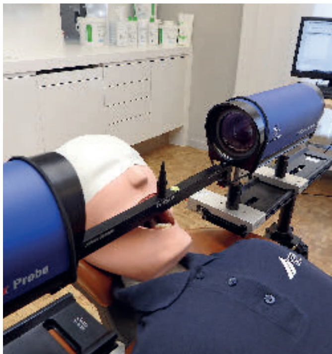
Abb. 4 Erstmalige Anwendung im dentalen Bereich: Schattenverfahren mit Lichtquelle für gepulste Hintergrundbeleuchtung (l.) und Optik (r.) zur Verfolgung jedes einzelnen Partikels zwischen 5 und 50 Mikrometern im Spraynebel.
